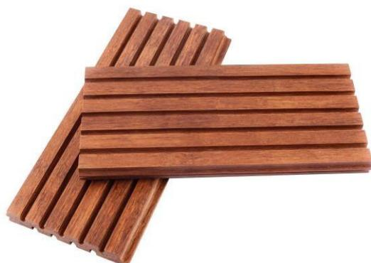
O revestimento de fachada em Bamboo é feito a partir de lamelas de **bamboo comprimidas a alta pressão**. Estas sofrem um **processo de tratamento de calor** - processo que modifica as moléculas de açúcar, que estão naturalmente presentes no bamboo não tratado, obtendo assim uma **maior preservação e resistência**.
